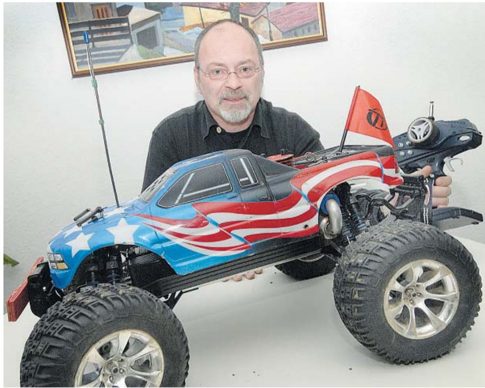
Armin Vondran mit seinem 2,1 PS-Gefährt. Die Reifen sehen stabil aus, sind aber weich wie Watte. Erst in extremen Kurven blasen sie sich auf, verursacht durch die hohe Drehung. F.: Lenk
