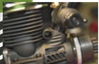
Falsche Anschluss-Seite...? Schraube raus, Vergaser drehen – fertig...!
