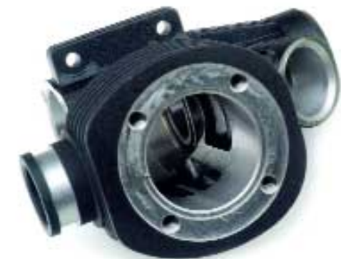
Ein Blick ins Innere des Gehäuses zeigt die großzügig dimensionierten Überströmkanäle
