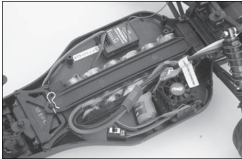
Typischer Einbau im Elektroauto
